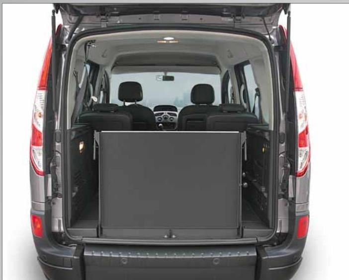
Sia nella versione automatica che in quella manuale la rampa in posizione di riposo assicura minimo ingombro e massima visibilità dal lunotto posteriore. Nella versione manuale la rampa, più lunga di quella automatica, si ripiega su se stessa prima di richiudersi.
