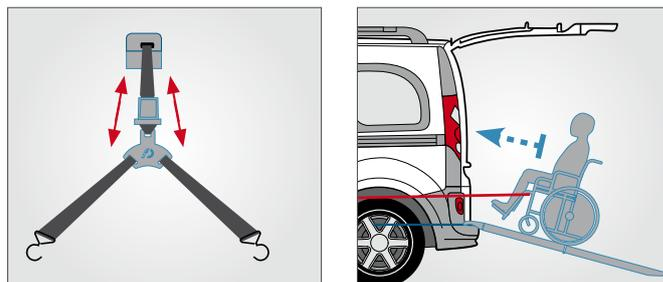
**F-Winch** è l'innovativo verricello elettrico che consente di trainare delicatamente la carrozzina sulla rampa di accesso mediante apposito comando a filo.
